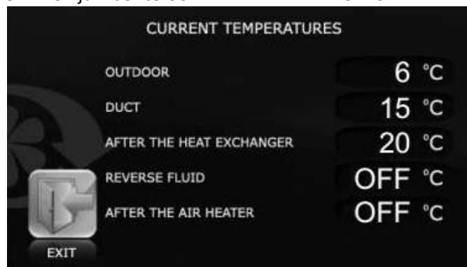
Prikazane bodo trenutne temperature, ki so zaznane na sami prezračevalni napravi:
