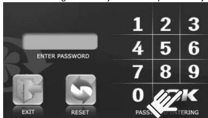
Po vnosu gesla pritisnite na tipko OK. V kolikor ste vnesli napačno geslo, pritisnite tipko RESET
