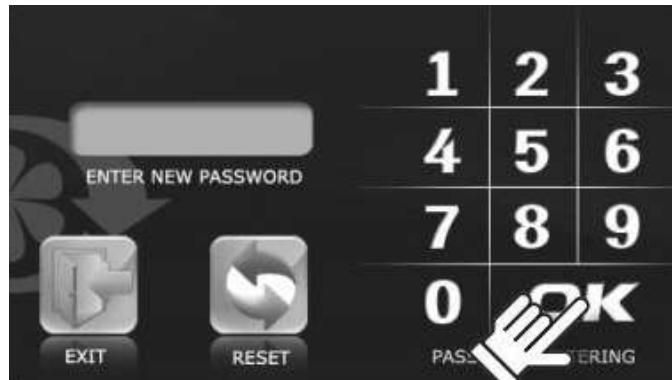
Nato izberite novo geslo za dostop v tehnični meni in pritisnite tipko OK za potrditev novega gesla. S tipko RESET lahko počistite polje za vnos gesla, v kolikor z vnesenim geslom niste zadovoljni ali je prišlo do napake. S tipko EXIT
