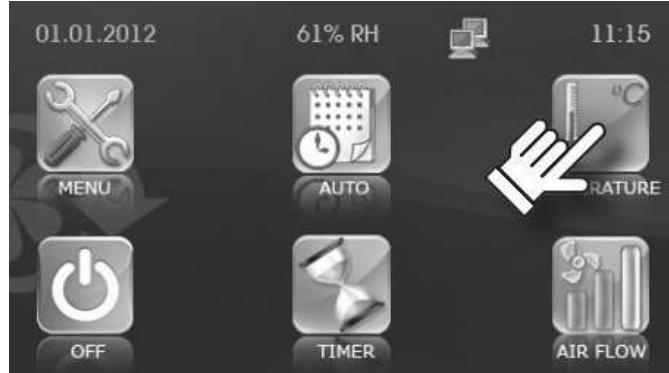
Po vstopu v podmeni za nastavitev temperature, lahko izberemo tipalo temperature, ki je nameščen v kanalu za zrak.
