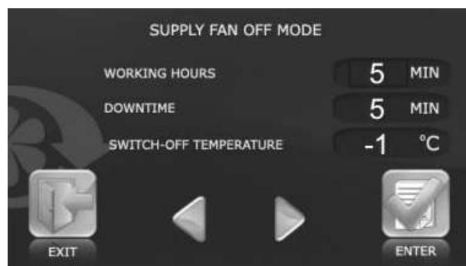
S pritiskom na primočno polje lahko izberete WORKING HOURS, DOWNTIME in SWITCH-OFF TEMPERATURE. Prva dva parametra definirata zamik ter interval funkcije, zadnji parameter za temperaturo za pričetek aktivacije funkcije. S tipko
