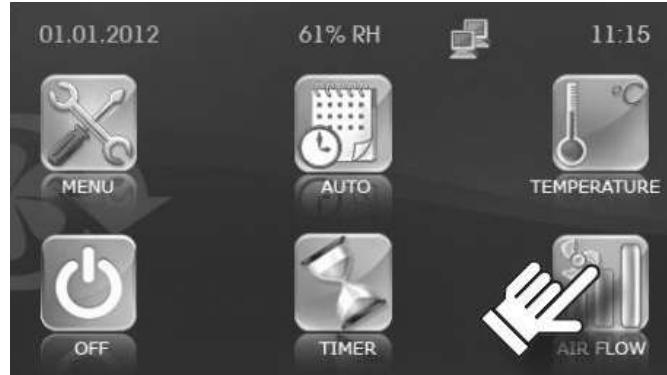
Za nastavitev pretoka zraka, pritisnite na ikono AIR FLOW, kot prikazuje zgornja slika. S pritiskom na ikono za nastavitev pretoka zraka vstopimo v podmeni, ki nam omogoča štiri različne nastavitev:
